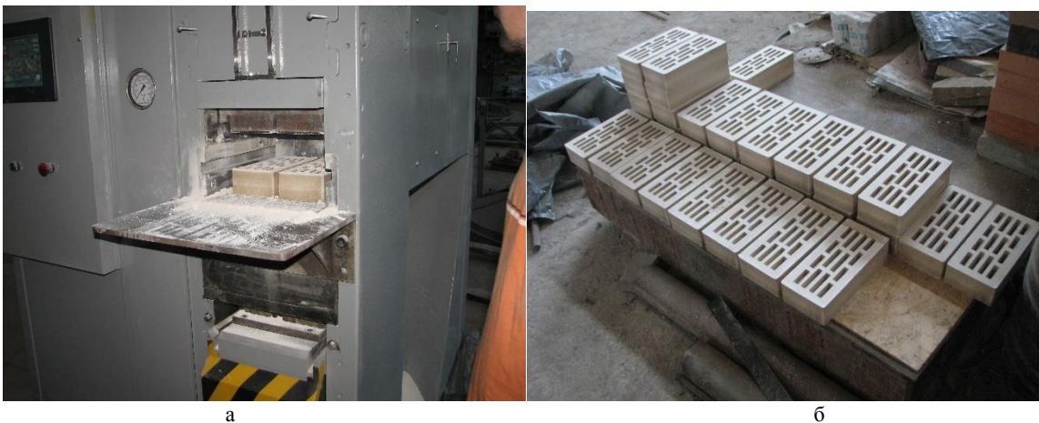
Рис. 3. Процесс формования (а) и вид полученного кирпича (б)
