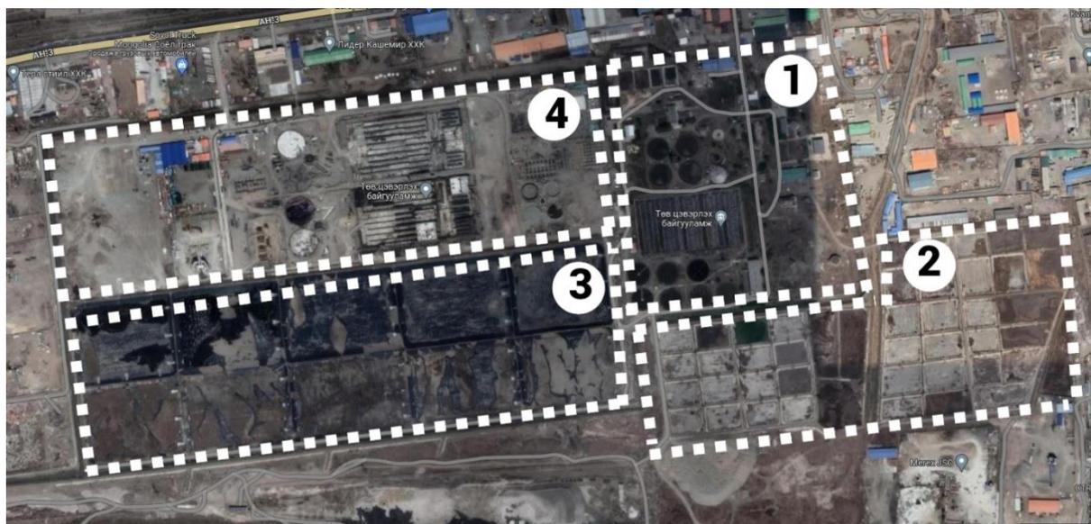
**Рис. 3.** Функционирующий и строящийся комплексы по очистке сточной жидкости города Улан-Батора (вид из космоса): 1 – функционирующие ОСК; 2 – иловые площадки действующего объекта; 3 – территория биологических прудов; 4 – строящиеся ОСК.
