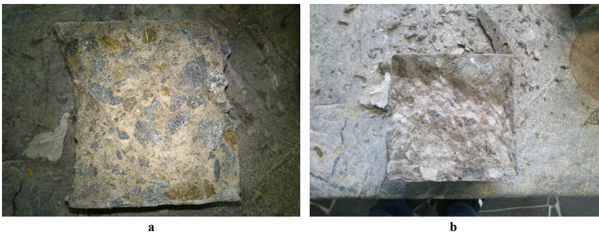
Рис. 3. Вид бетона опытных образцов после испытания на прочность на сжатие в возрасте 548 сут, выдерживание которых проходило: а – в нормальных условиях; б – в агрессивной среде
